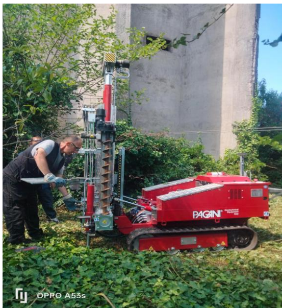
Caratteristiche Tecniche-Strumentali Sonda: DPSH TG 63-200 PAGANI
