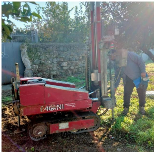
Caratteristiche Tecniche-Strumentali Sonda: DPSH TG 63-200 PAGANI
